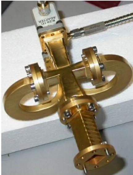
Figura 1- Unità MECSA dell'Università di Firenze: progetto e realizzazione di un polarizzatore (in collaborazione con l'Istituto di Radioastronomia dell'INAF)
