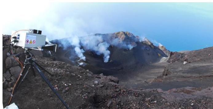
Monitoraggio della caldera dello Stromboli mediante un radar progettato dal DINFO
