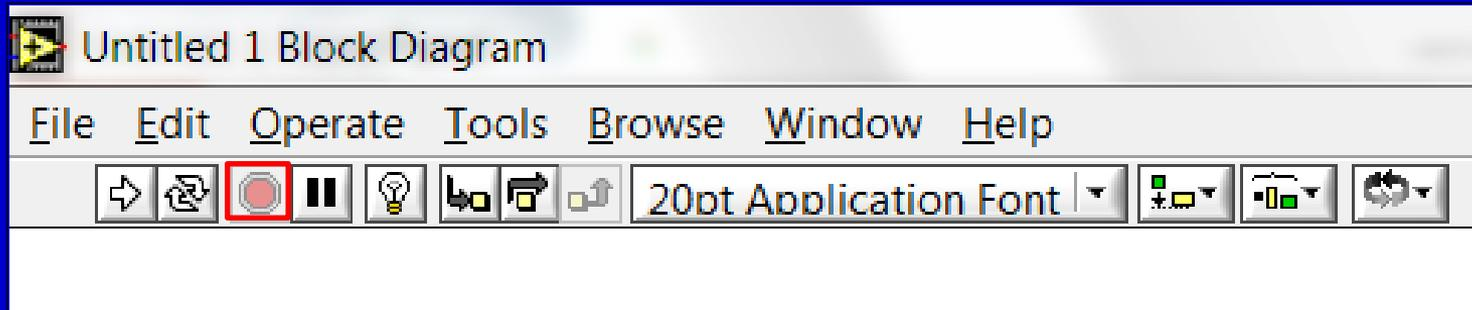
**ABORT EXECUTION** è attivo quando il VI è in esecuzione, premendolo si arresta il programma: il suo utilizzo è da evitare perché l'esecuzione viene interrotta bruscamente
